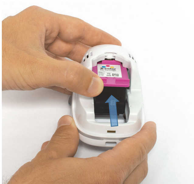
Obr. 47: Vloženie atramentovej kazety
