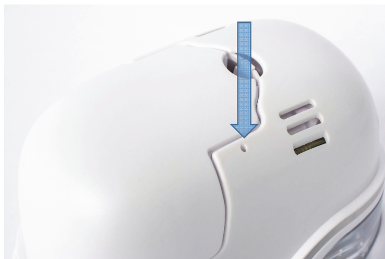
Obr. 52: Otvor pre obnovenie výrobných nastavení zariadenia
