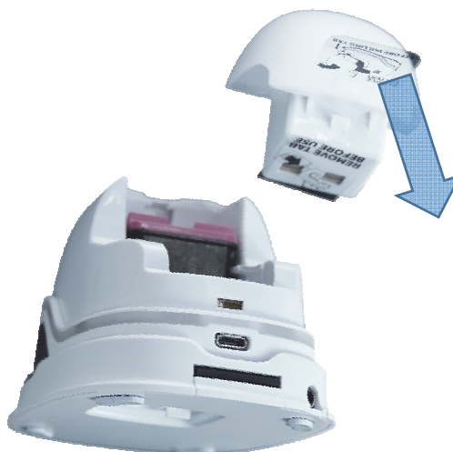
Obr. 10: Izolačná páska chrániaca kontakty batérie
