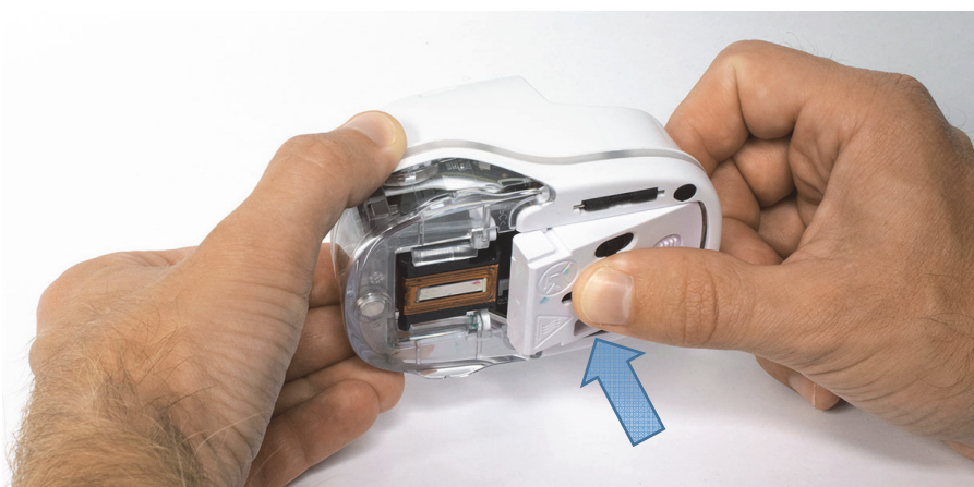
Obr. 48: Zatvorte spodný záklopkový kryt
