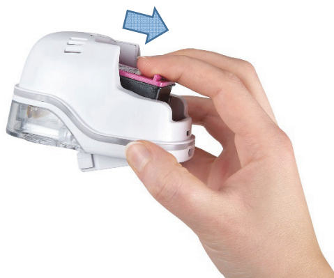
Obr. 45: Vytiahnite atramentovú kazetu
