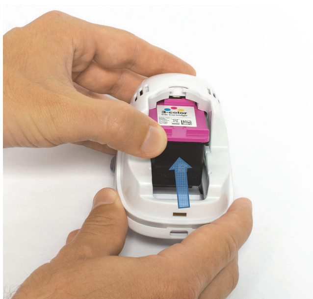
Obr. 13: Vloženie atramentovej kazety
