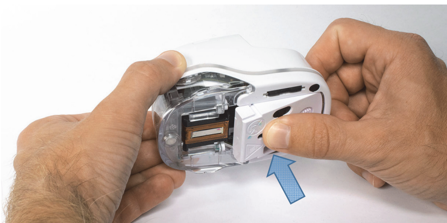
Obr. 14: Zatvorenie spodného záklopkového krytu
