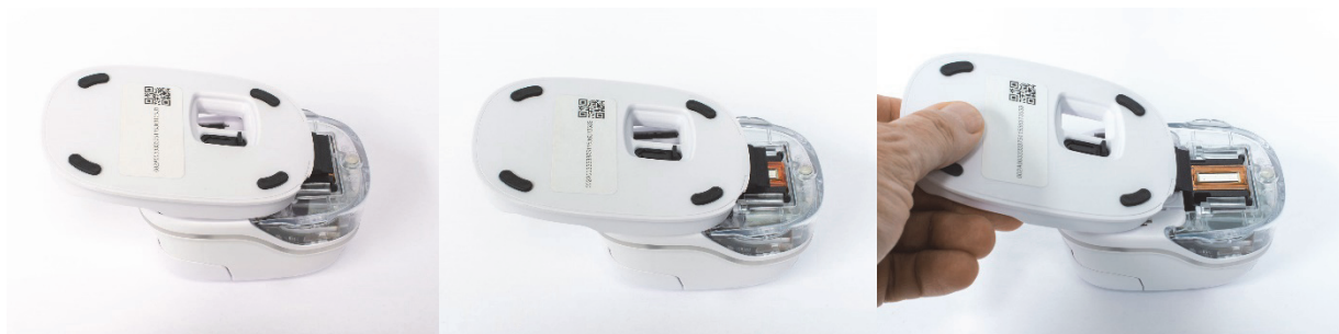
Obr. 29: Vyčistenie tlačovej hlavy stieracím mechanizmom
